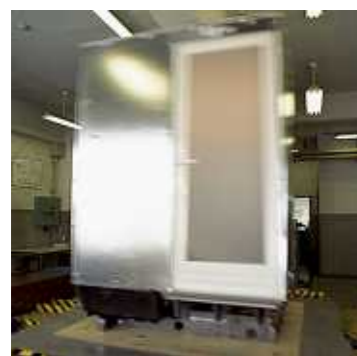
震度6強の地震に耐える、フレーム構造の土台 耐震システムバス
